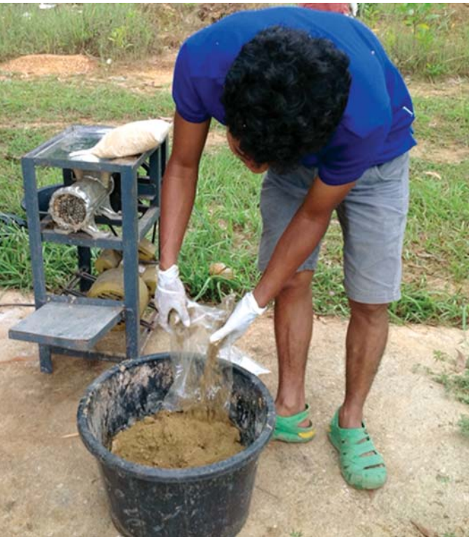
ภาพที่ 71 ซึ่งวัตถุดิบอาหารตามสูตร ผสมส่วนผสมทั้งหมดให้เข้ากัน และนำเข้าเครื่องอัดอาหาร
