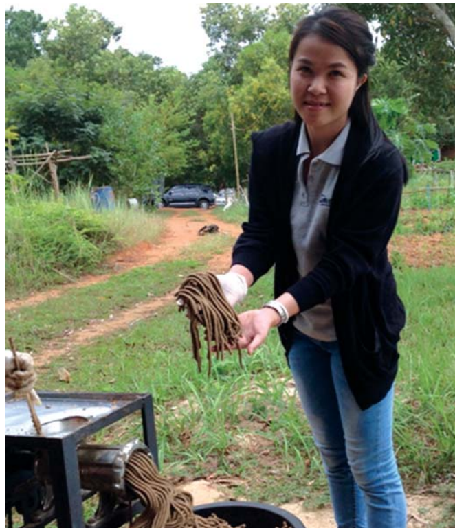
ภาพที่ 71 ซึ่งวัตถุดิบอาหารตามสูตร ผสมส่วนผสมทั้งหมดให้เข้ากัน และนำเข้าเครื่องอัดอาหาร
